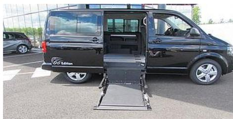
Hayon élévateur sous plancher
