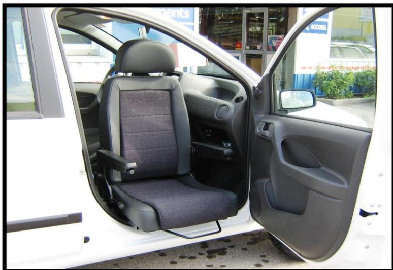
L'embase TURNOUT constitue une aide précieuse pour les personnes qui éprouvent des difficultés à monter et descendre de leur véhicule, **Il permet au siège de pivoter de 90°**
