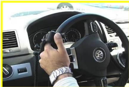
Dispositif innovant : une gâchette fixée sur une petite poignée permet d'accélérer à l'aide du pouce droit ou gauche avec une très grande précision de dosage. La discrétion et la précision sont les points forts de ce produit qui n'encombre ni le volant ni le tableau de bord en général. Le système se retire simplement en débranchant une prise, ne laissant rien apparaître sur le véhicule.
