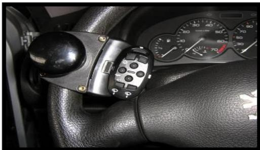
télécommande infrarouge avec boule au volant pour main Gauche ou droite, fonctions phares, essuie glace, lave glace, clignotants, warning, avertisseur, capteur crépusculaire, alimentation sur piles , taille réduite
