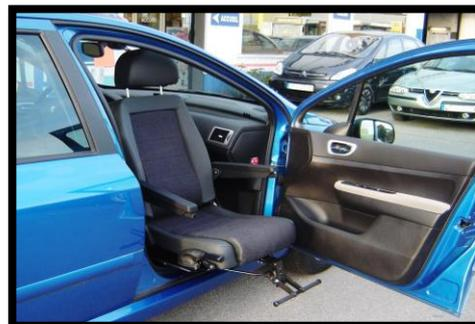
Le pivotement du siège au niveau du seuil facilite considérablement l'entrée et la sortie du véhicule en cas de mobilité réduite ou d'utilisation d'un fauteuil roulant.
